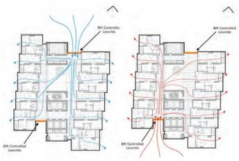
Figure 5. Internal Flow Paths for the Prevailing Winds. (Source: Windtech Consultants) 图5. 主风室内空气流线谱。(来源: 澳风载建筑工程咨询公司)
